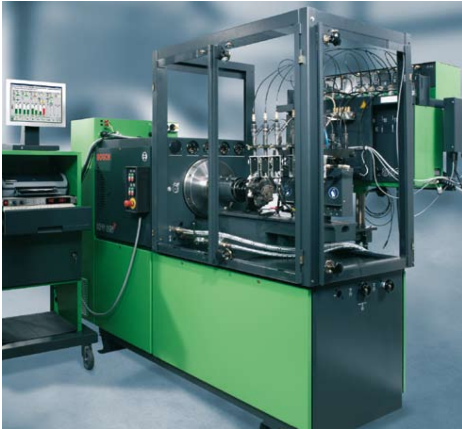
EPS 815 : Le banc d'essai professionnel pour les composants diesel
