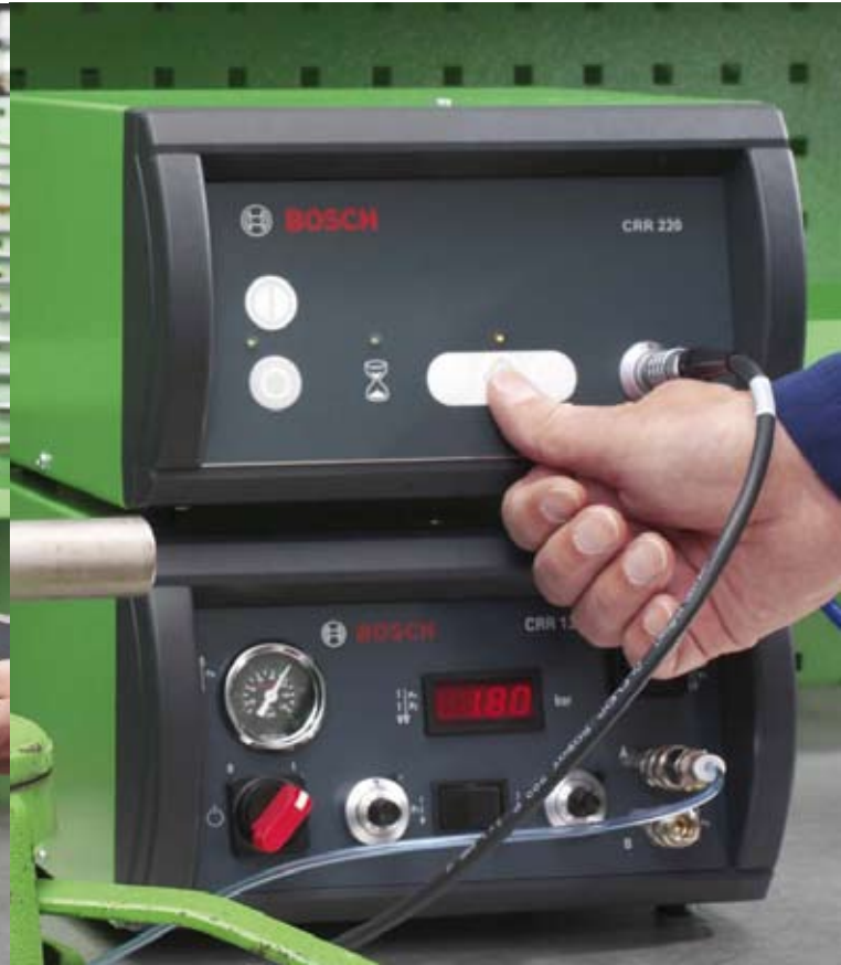
Mesure de l'unité de contrôle pneumatique et de course du noyau
