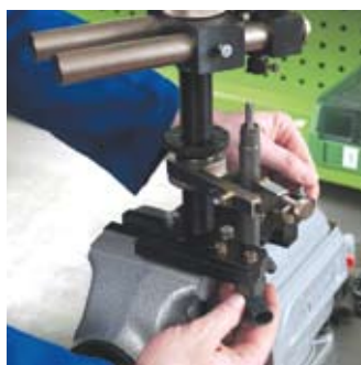
Niveau 1 : remplacement des buses
