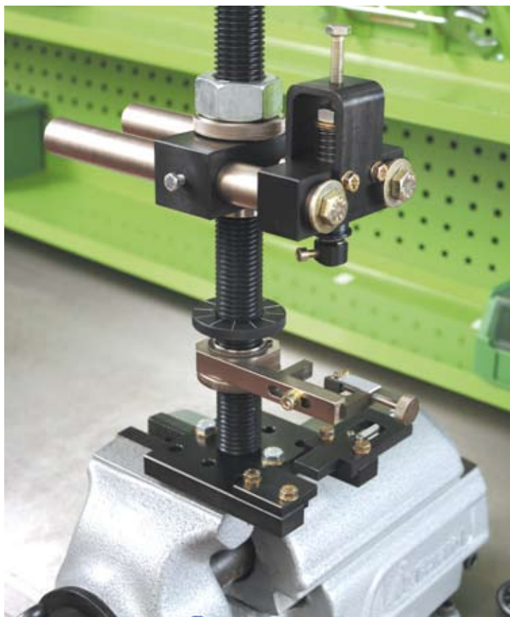
Outil de pose d'injecteur, niveau 1
